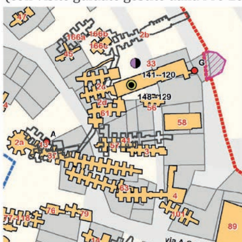
Fig. 31 – Complesso delle cavità monumentali comunali (2a, 2b e 2c). Nell'areale esistono quattro livelli di cavità ipogee sovrapposti. Le cavità 166a, 166b e 166c sono state scoperte nel 2019 durante lavori di ristrutturazione di un edificio).
